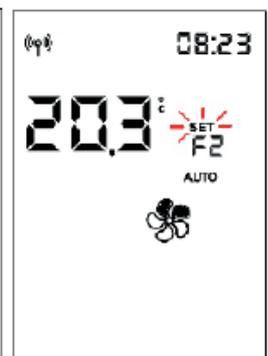
Con la tecla
