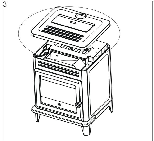
4. Desenroscar los dos tornillos de cada lado de los soportes debajo de la tapa
